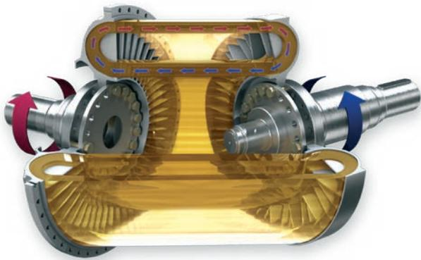
La roue de pompe entraînée par le moteur transmet, par l'intermédiaire d'un liquide de travail, la puissance sans usure mécanique à la roue de turbine qui entraîne elle-même la machine à entraîner.
