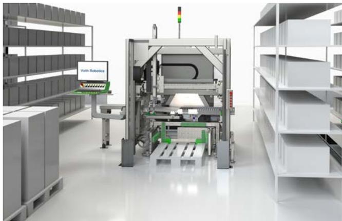
自动化流程只有在流畅运行时才能真正实现高效。在这里，向机器人供给零件以及高品质零件托盘堆垛或装箱的工序都尤为重要。由于零件或庞大沉重，或细小轻微，因此就需要灵活的智能解决方案。福伊特机器人所推出的堆垛机器人所提供的正是这种解决方案。该零件装运系统体型小巧，通过三根互相垂直的线性轴组成的笛卡尔坐标系实现运作，另有一根可实现0度至270度角度范围的旋转轴作为补充。
