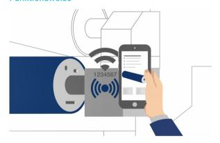
Das Modul "ID Tagging" ist eine Kombination aus kontaktlosen Verbindungstechnologien und der Integration digitaler Typenschilder. Es bietet eine einfache und benutzerfreundliche Kennzeichnung von Walzen und Bespannungen und ermöglicht dadurch eine nahtlose Identifizierung. Dies geschieht durch das Scannen eines ID Tags, bei Walzen, oder eines QR Codes, bei Bespannungen.
