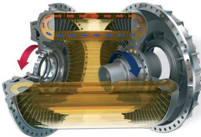
El acoplamiento funciona con una cantidad constante de fluido de operación, que suele ser aceite mineral. Pueden crearse diseños para funcionamiento con agua, previa petición. El par transmitido por el motor de accionamiento es convertido en energía cinética del fluido de operación en la rueda bomba donde se conecta el motor. En la rueda de la turbina, esta energía cinética se convierte de nuevo en energía mecánica. Existen tres modos de funcionamiento definidos:
