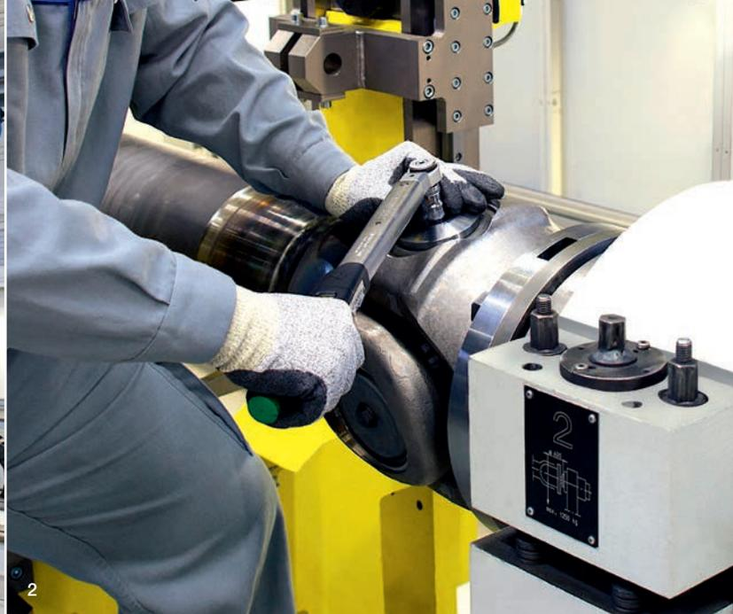
1 Máquina de balanceamento dinâmico
