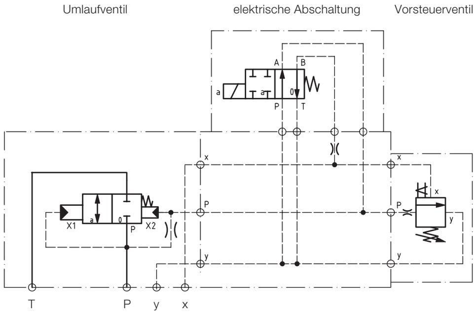
In der geöffneten Stellung ist das Ventil stromlos. Dadurch ist P mit y (Tank) verbunden und das Speicherladeventil schaltet immer auf drucklosen Umlauf. Der Speicher an P ist ebenfalls mit y (Tank) verbunden und wird somit entleert.
