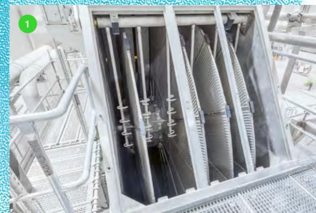
1 BaglessPlus Filterscheiben bieten dauerhaft eine exzellente und gleichmäßige Filtratqualität, die wiederum zu einer signifikanten Reduzierung der Faserverluste und des Frischwasserbedarfs führt.
