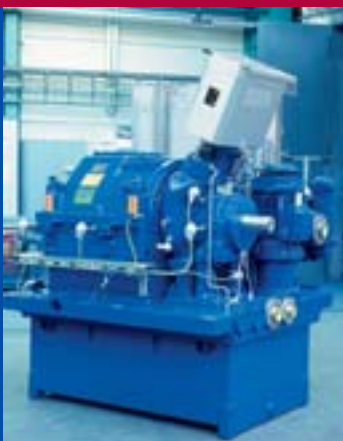
Регулируемая редукторная муфта ф. Voith типа R..K..M
