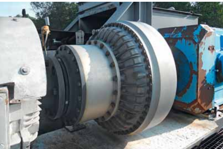
O acoplamento hidrodinâmico TVVS altamente confiável da Voith encontra-se em funcionamento desde 1997 na mina Tanjung Enim sem nenhuma parada não planejada.
