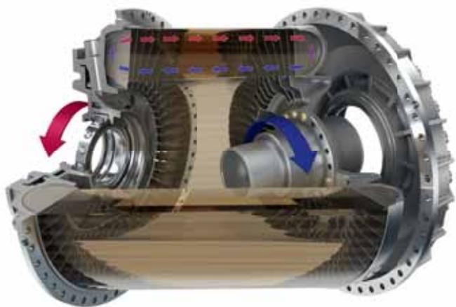
Elegantes en su simplicidad, los acoplamientos hidráulicos son capaces de transmitir grandes potencias a máquinas y transportadores, de forma suave y eficiente.
