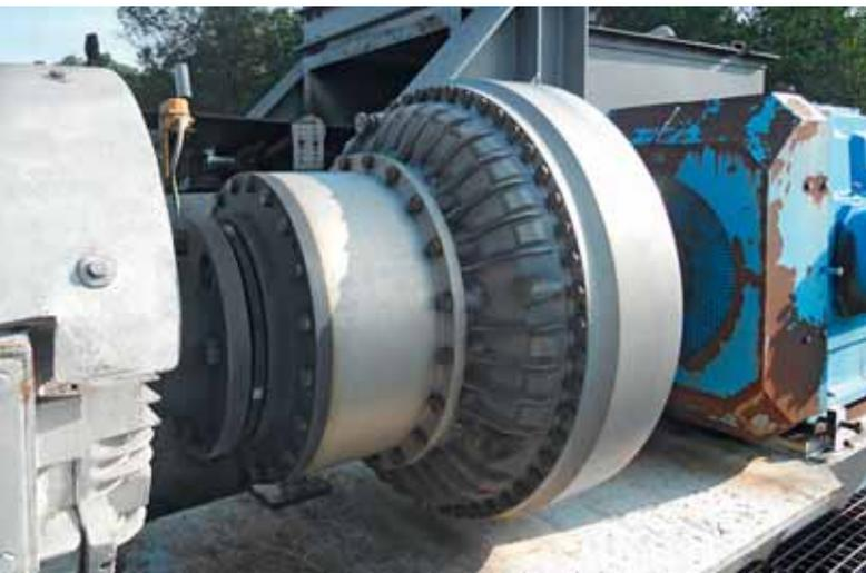
El altamente confiable acoplamiento hidráulico TVVS de Voith ha estado en funcionamiento desde 1997 en la mina Tanjung Enim sin presentar ningún tiempo de inactividad inesperado.
